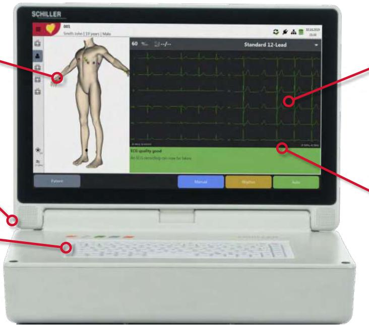
Detección de inversión de derivaciones antes de adquirir el ECG.
